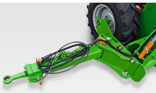
✓ Транспортное дышло в разложенном состоянии
