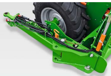
✓ Транспортное дышло складывается при посеве
