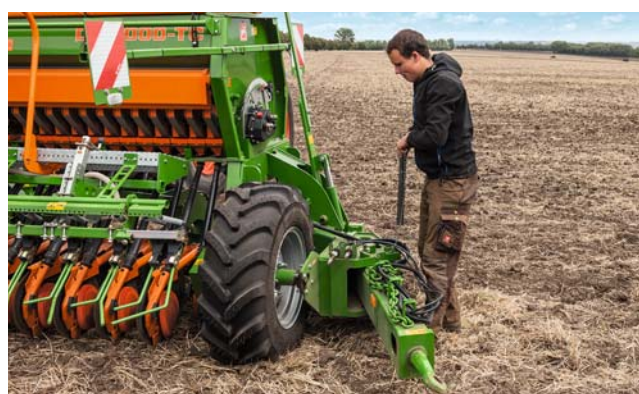
Продольное шасси со складываемым транспортным дышлом
