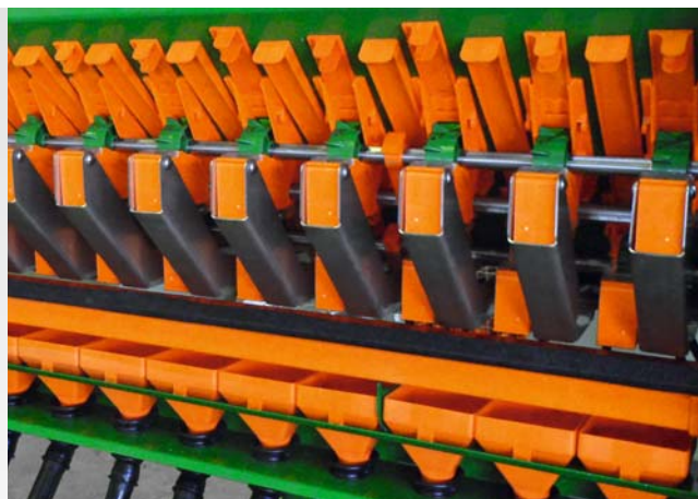
Дозирование посевного материала и удобрений
