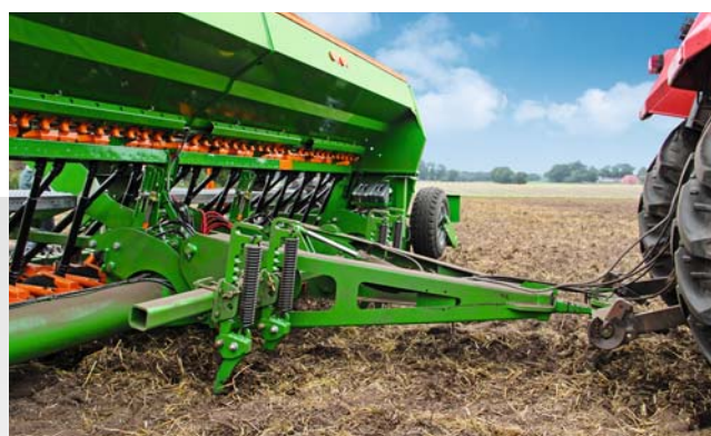
Поддрессоренный следорыхлитель следа трактора
