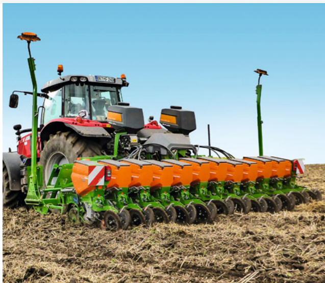
ED 6000 с 12 рядами и распределителем микрогранулята Micro plus
