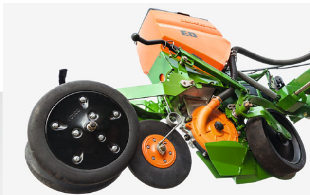
Высевающий агрегат Contour с дополнительным прикатывающим каточком
