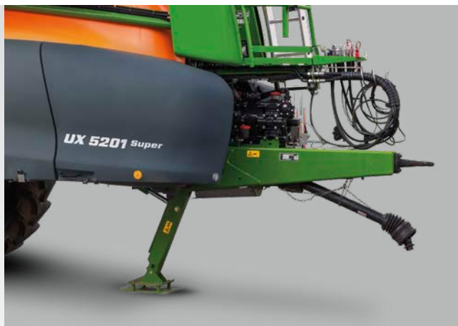
Дышло с верхним зацеплением с прицепной серьгой и гидравлической стояночной опорой
