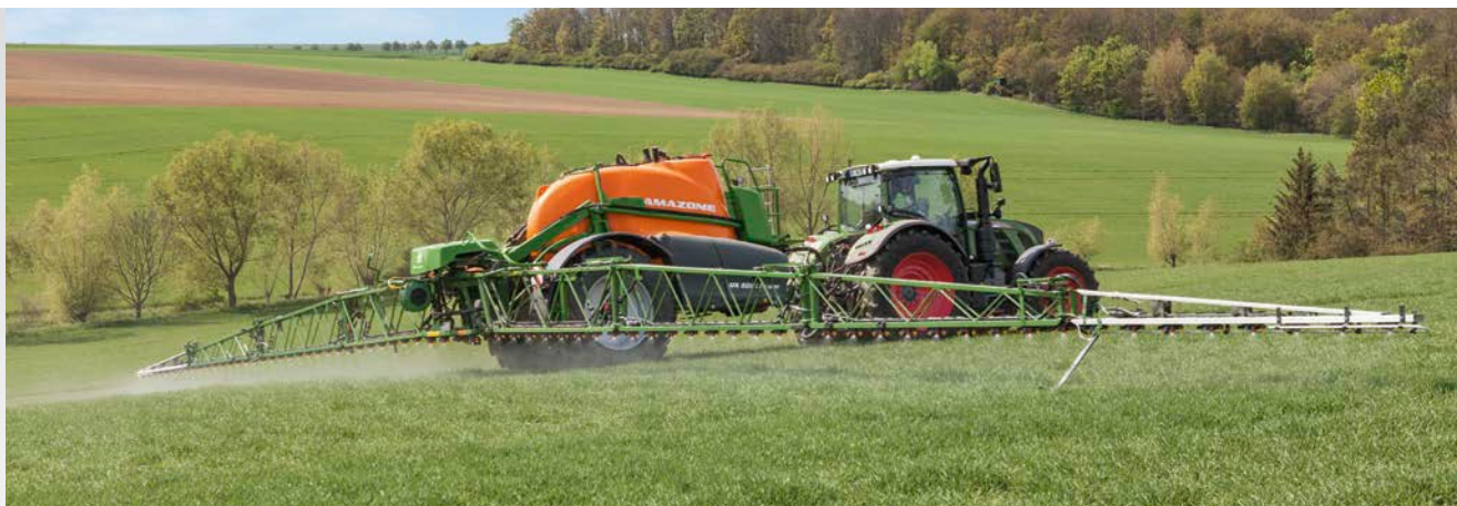
ContourControl с отклонением штанги вниз
