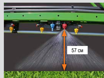
Форсунка 110°: Расстояние между форсунками 50 см
