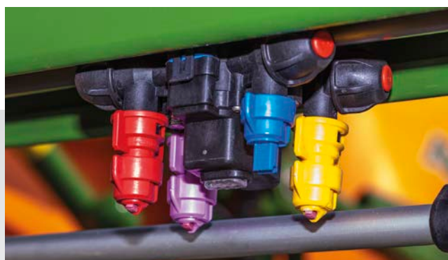
Электрическое пофорсуночное включение AmaSelect
