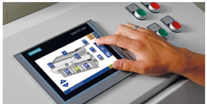
Управление параметрами, потоком воздуха, углом наклона стола, подачей и скоростью вибрации осуществляется с помощью простой в использовании сенсорной панели. Все настройки могут быть сохранены для достижения исключительных и повторяемых результатов сортировки. Сенсорная панель также информирует пользователя о необходимости сервисного обслуживания и возможных неисправностях на нескольких языках.
