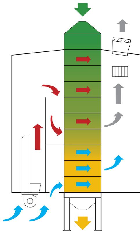
**Сушилки непрерывного действия типа DD** компании **PETKUS** представляют собой шахтные сушилки для сушки зерна и семенного материала. Сушилки поставляются в трех типоразмерах (15, 25, 40).
