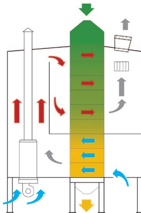
**Сушилки непрерывного действия типа DW** компании **PETKUS** представляют собой шахтные сушилки для сушки зерна, маслических семян и семенного материала. Сушилки поставляются в четырех типоразмерах (15, 20, 40 и 60).
