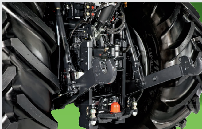
↑ Нижние тяги в транспортном положении.
