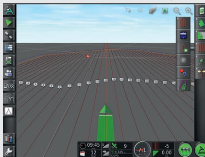
↑ В iMonitor3 интегрированы все функции управления полосой.
