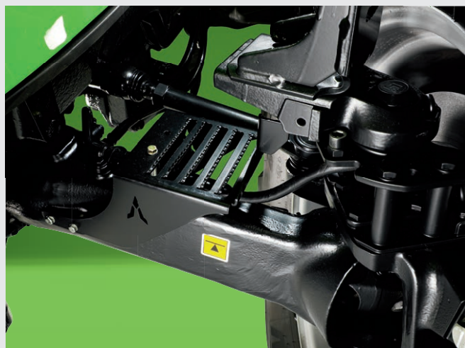
↑ Удобные ступеньки над передним мостом для технического обслуживания и очистки.
