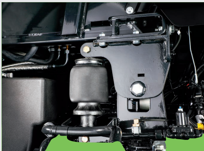
↑ Пневматическая подвеска кабины, амортизирующая удары и толчки.
